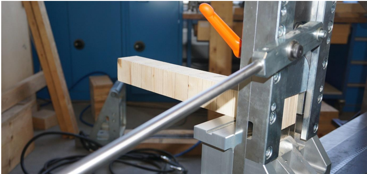
Abbildung 8: Druckscherprüfung eines Brettschichtholzabschnitts gemäß EN 14080, Anhang D
