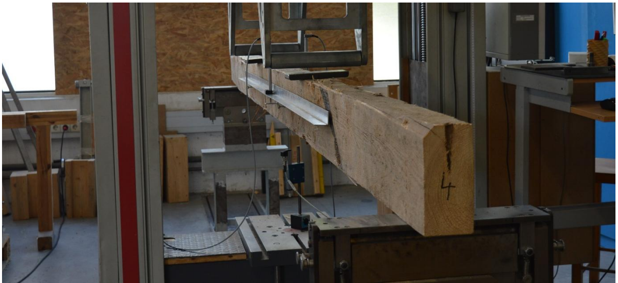
Abbildung 6: Eingespannter Kantholzbalken bei der 4-Punkt-Biegeprüfung
