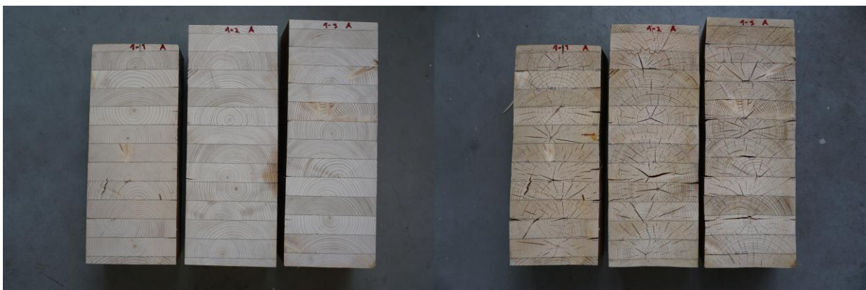
Abbildung 9: Proben aus altem BSH vor (links) und nach (rechts) der Delaminierungsprüfung
