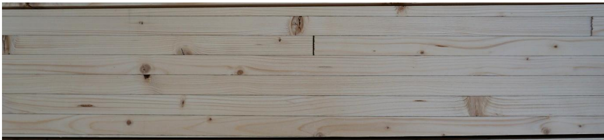
Abbildung 11: Aus Brettschichtholz herausgetrennte Stablamelle mit 7 verbundenen Einzelstäben
