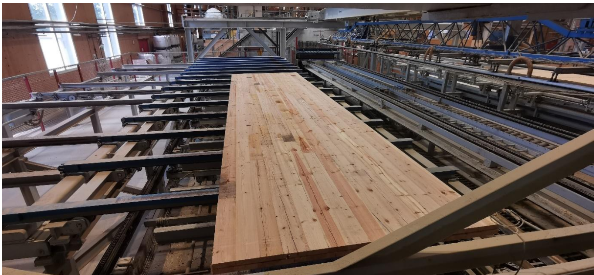
Abbildung 13: Einschichtplatten aus Altholzlamellen vor der Flächenverklebung zu Brettsperrholz
