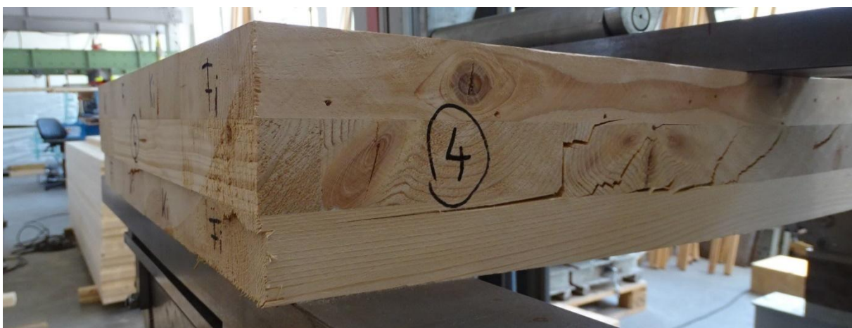
Abbildung 16: Brettsperrholzplatte aus Altholzlamellen bei der 4-Punkt-Rollschubprüfung
