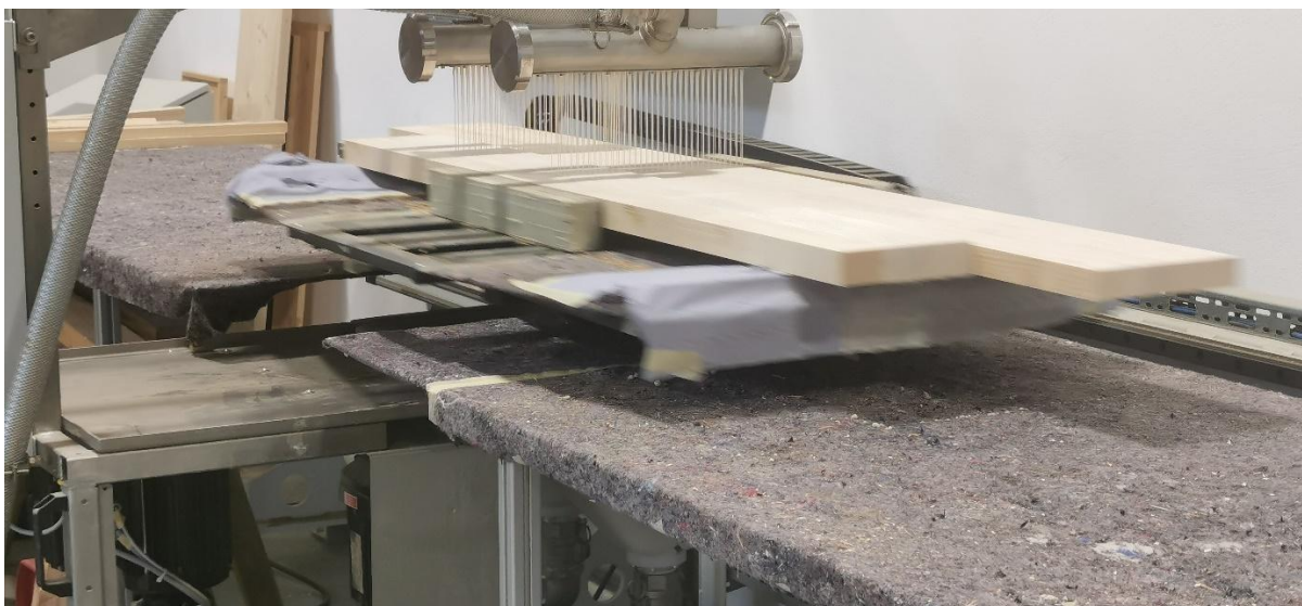
Abbildung 14: Altholzlamellen beim Klebstoffauftrag vor dem Verpressen zu neuem Brettschichtholz
