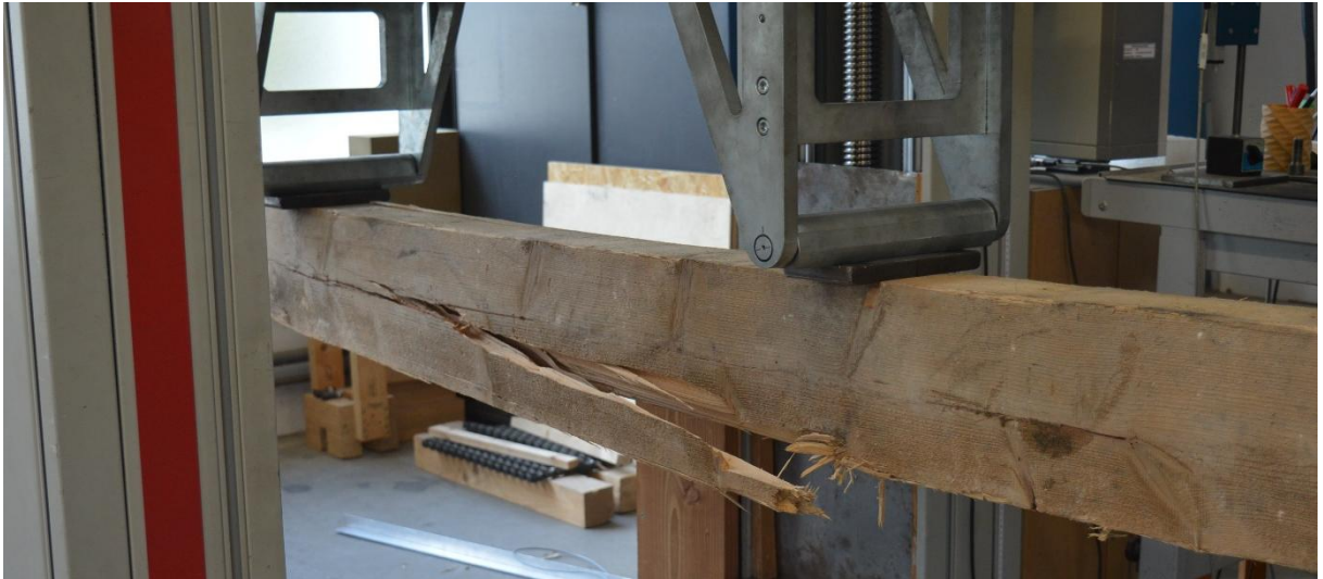
Abbildung 20: Charakteristischer Biegebruch eines alten Kantholzbalken
