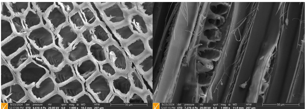
Abbildung 41: Rasterelektronenmikroskopische Aufnahmen einer Druckscherprobe nach der Druckscherprüfung in axialer Richtung (links) und radialer Richtung (rechts)
