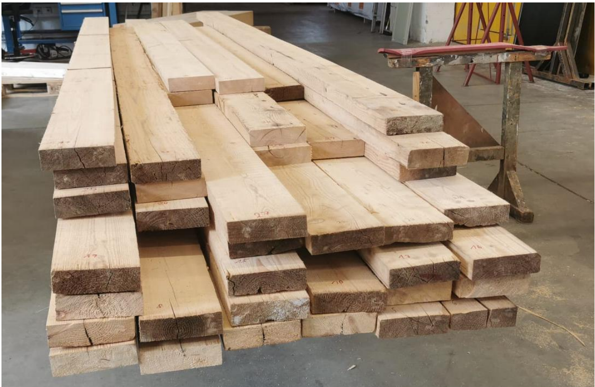
Abbildung 12: Aufgetrennte Altholzlamellen aus Altholzsortimenten vor der Weiterverarbeitung
