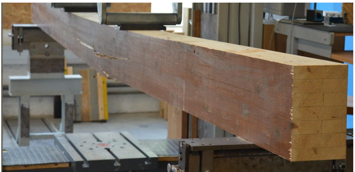
Abbildung 7: Eingespannter Brettschichtholzabschnitt bei der 4-Punkt-Biegeprüfung
