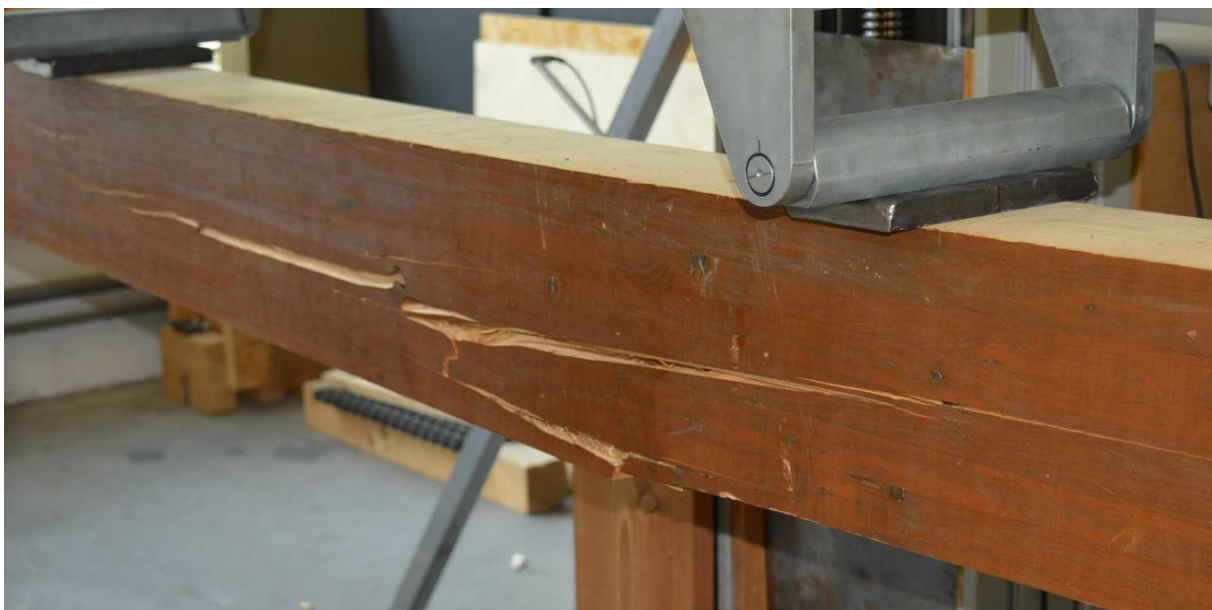
Abbildung 22: Charakteristischer Biegebruch eines Brettschichholzabschnitts in der Zugzone
