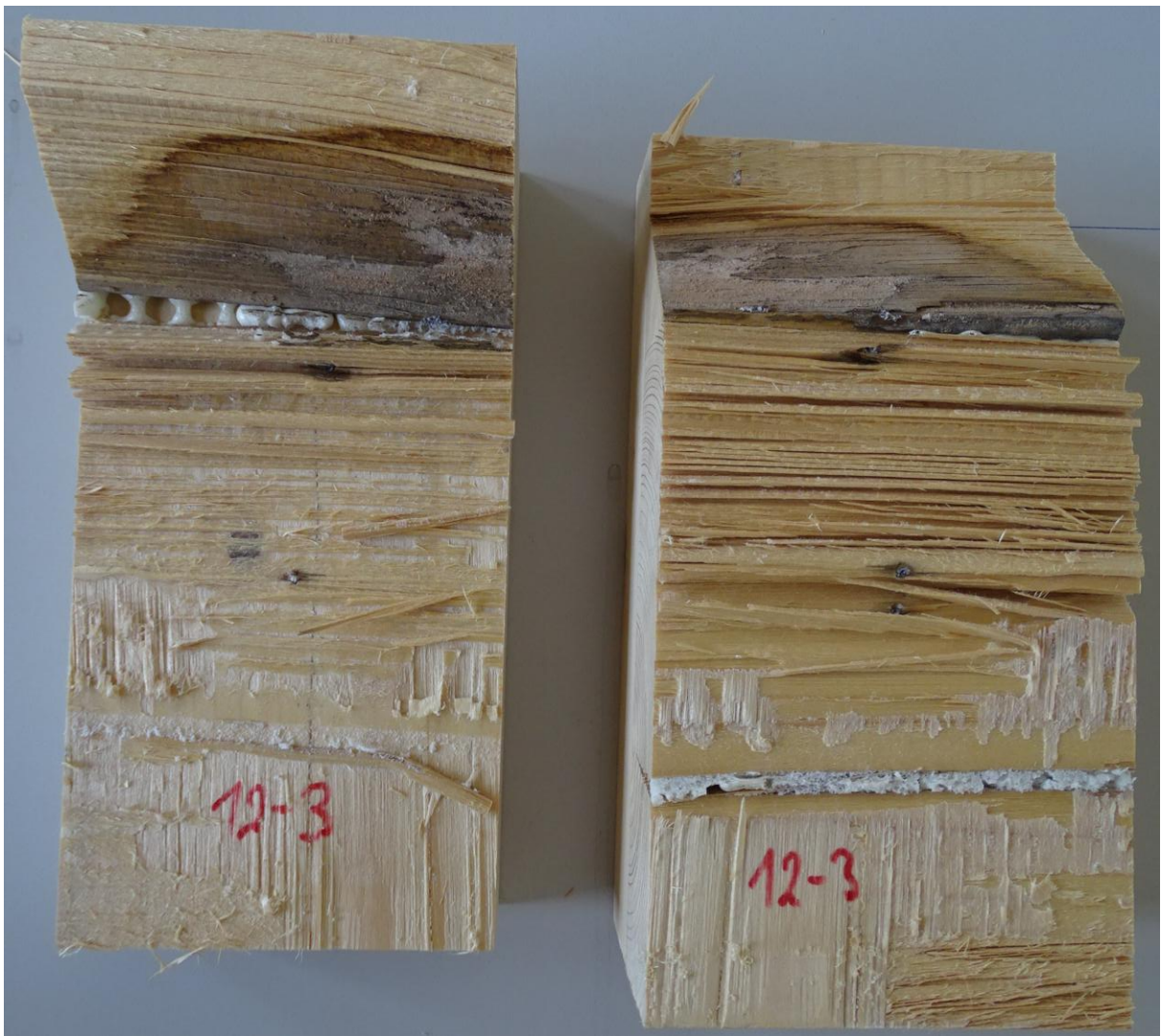
Abbildung 40: Bruchfläche einer Druckscherprobe eines neu hergestellten Brettsperrholzelements aus Altholzlamellen nach der Prüfung
