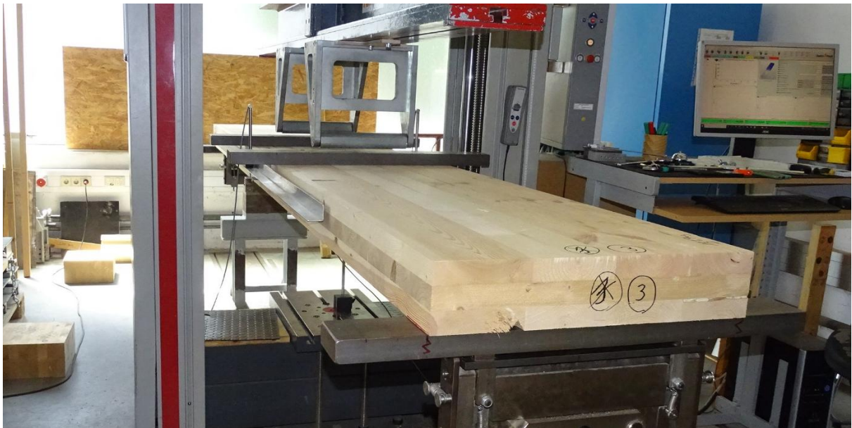
Abbildung 15: Brettsperrholzplatte aus Altholzlamellen bei der 4-Punkt-Biegeprüfung
