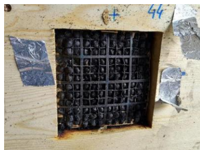
Abb. 39: Promat - PROMASTOP®-IM Gitter-Lüftungsbaustein: Verschluss durch intumeszierendes Material
