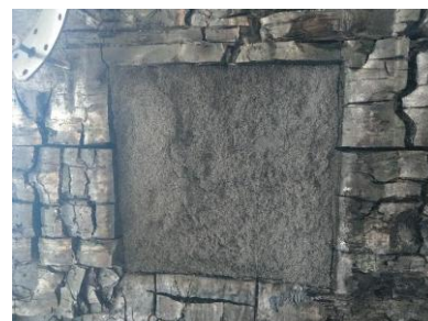
Abb. 39: Promat - PROMASTOP®-IM Gitter-Lüftungsbaustein: Verschluss durch intumeszierendes Material
