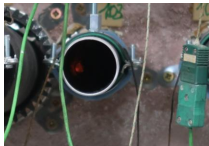
kurz nach Beginn der Prüfung geschlossene Brandschutzmanschette nach Ende der Prüfung (Brandseite) Abb. 38: AIR FIRE TECH - RORCOL V30 – Brandschutzmanschette: Verschluss durch intumeszierendes Material
