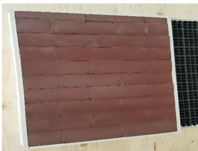
Prod. 22: Steinschott: Promat – PROMASTOP®-FB mit Laibungsbekleidung
