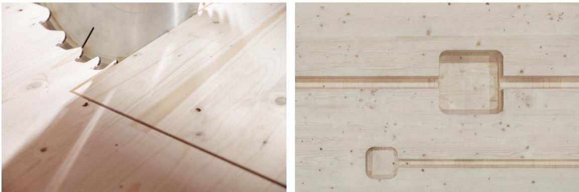
Abb. 6: CNC-gesteuerte Bearbeitung von Brettsperrholz (Quelle: Stora Enso Oyj)
