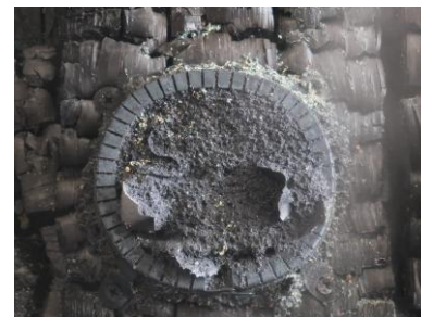
kurz nach Beginn der Prüfung geschlossene Brandschutzmanschette nach Ende der Prüfung (Brandseite) Abb. 38: AIR FIRE TECH - RORCOL V30 – Brandschutzmanschette: Verschluss durch intumeszierendes Material
