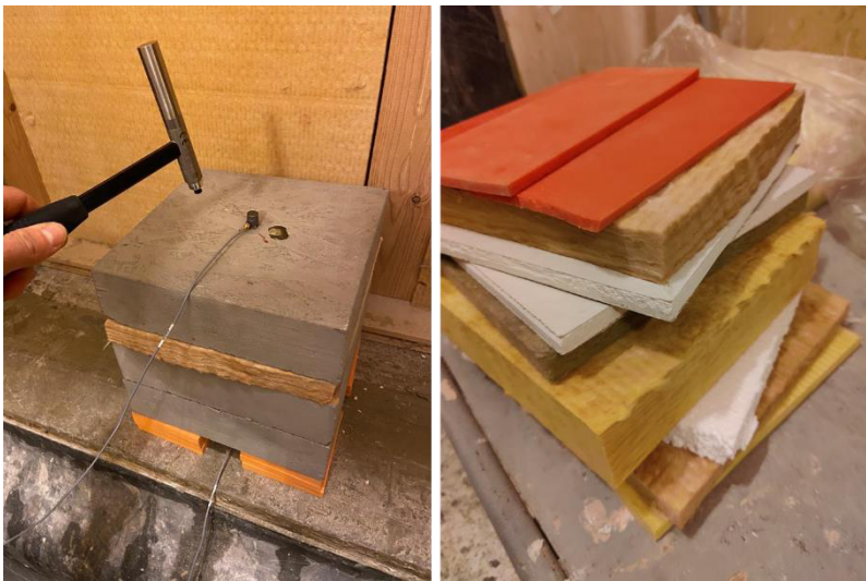
Abbildung 8: Messaufbau bestehend aus insgesamt drei Betonblöcken (25 cm x 25 cm x 7 cm) einer elastischen Zwischenschicht bestehend aus unterschiedlichen Trittschalldämmplatten und einem Auflager aus Elastomer (3 x 12,5 mm) (links) Variation an Materialien die als elastische Zwischenschicht eingesetzt wurden (rechts)
