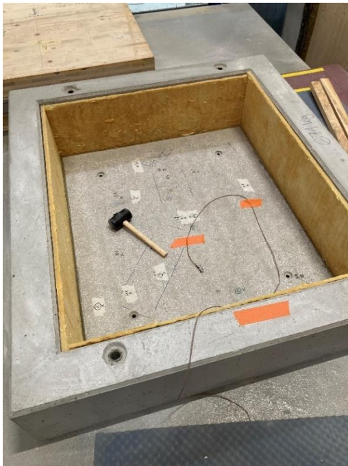
Abbildung 5: Verkleinerte Deckenöffnung mit eingebauter Grunddecke (aus Beton) ohne Bodenaufbau, anregeseitig
