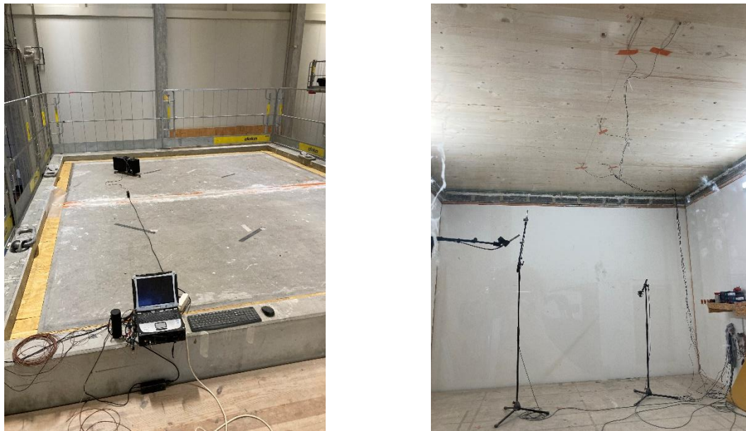
Abbildung 1: Messsituation am M-Prüfstand des Akustik Center Austria. Links: Estrich mit Messtechnik auf der Versuchsdecke (Anregeseite), rechts: Untersicht einer Versuchsdecke mit angebrachten Beschleunigungssensoren im Empfangsraum
