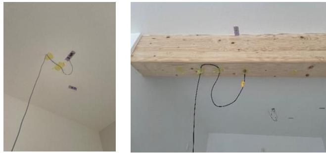
Abbildung 50: Beschleunigungsaufnehmer an der abgehängten Decke und am Holzbalken
