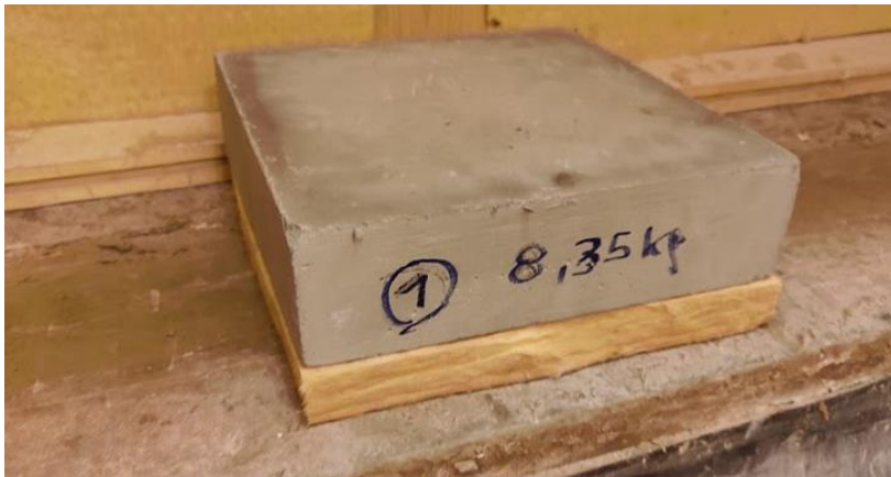
Abbildung 9: An das Messverfahren der ÖNORM EN 29052-1:1993 angelehnte Versuchsaufbau zur Bestimmung der dynamischen Steifigkeit und des Dämpfungskoeffizienten der elastischen Zwischenschichten als Trittschalldämmung
