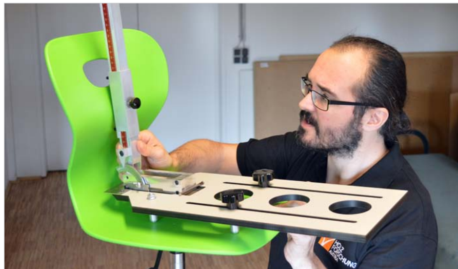
Michael Truskaller positioniert die Schulstuhl-Messvorrichtung auf einem nach der überarbeiteten ÖNORM A 1650 möglichen, höhenverstellbaren Schülerdrehstuhl
