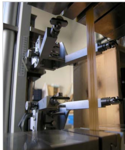
Links: Zugversuch an freien Beschichtungsfilmen; rechts: Zero-Span Zugversuch: die Dehnung der Beschichtung bis zum Reißen wird mittels Kamera ermittelt
