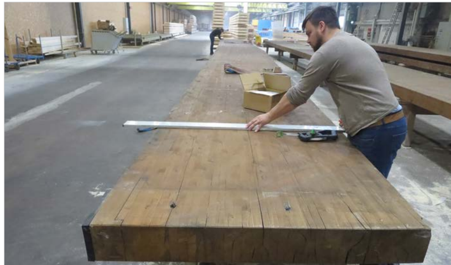
Brettschichtholzträger werden für die Auftrennung zu Stablamellen vorbereitet
