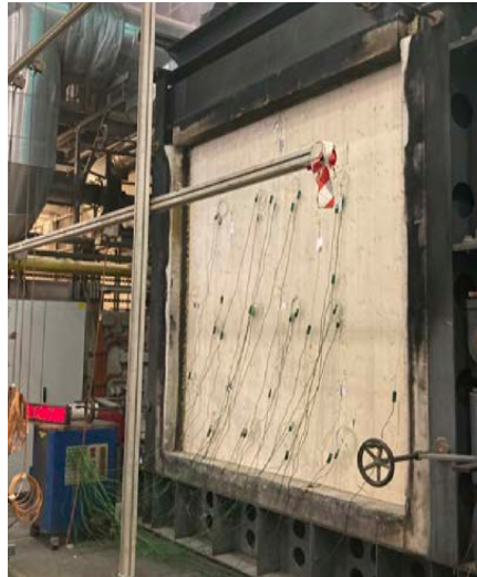
Brandversuch der Brettsperrholzwand mit Lehm- bauplatte nach 95 Prüfminuten (links) und im Zuge der Ablöscharbeiten (rechts)
