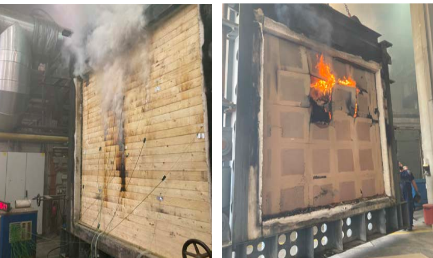
Brandversuch der Holzrahmenwand mit Lehmbauplatte nach 68 Prüfminuten
