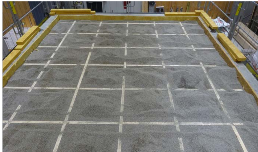
Durch ein Lattenraster mechanisch gebundene Splittschüttung einer BSP-Decke im Deckenprüfstand des Akustik Center Austria
