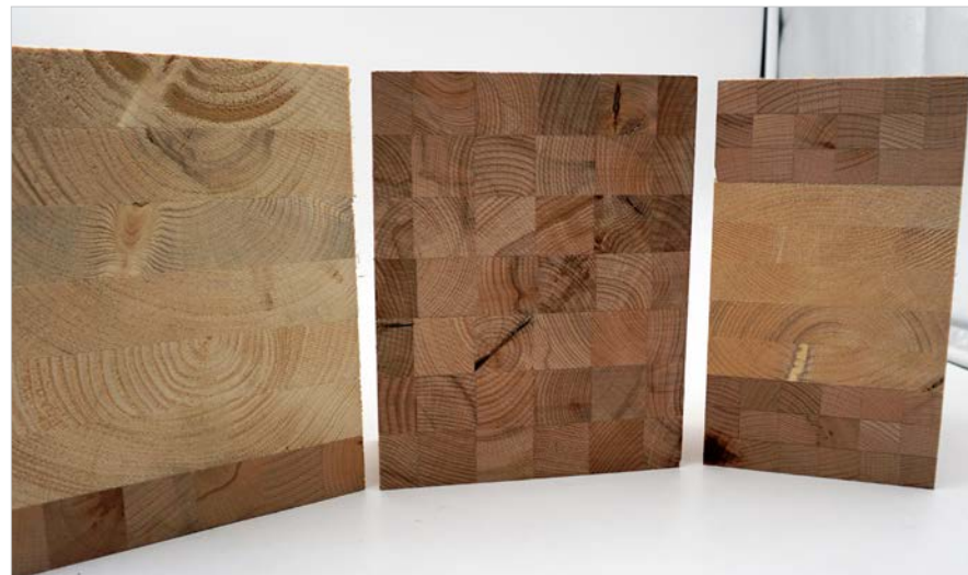
Verklebte Holzbauprodukte mit Stablamellen aus Buche. Links: homogener BSH-Aufbau, Mitte: hybrider, kombinierter BSH-Aufbau mit Kern aus festigkeitssortierten Fichtenlamellen, Rechts: BSP-Aufbau (stehend abgebildet) mit Kern aus Buchenstablamellen.
