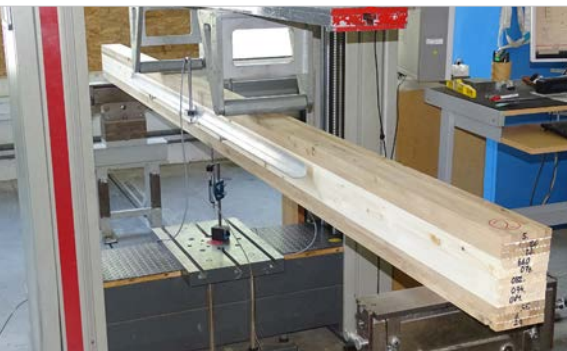
4-Punkt Biegeprüfung eines hybriden kombinierten Brettschichtholzaufbaus aus Eichenstablamellen und einem Fichtenkern
