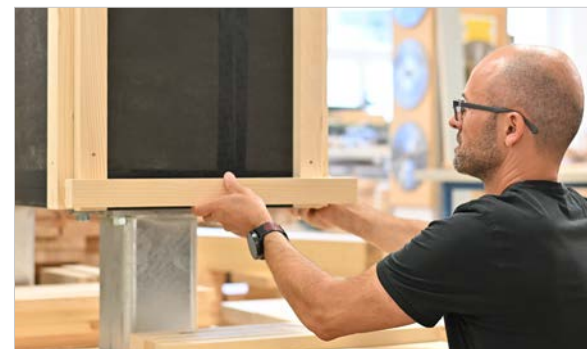
Montage der Versuchskörper der Überkopfwegweiser aus Holz
